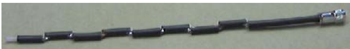
Construcció d'una antena omnidireccional amb GR-213
