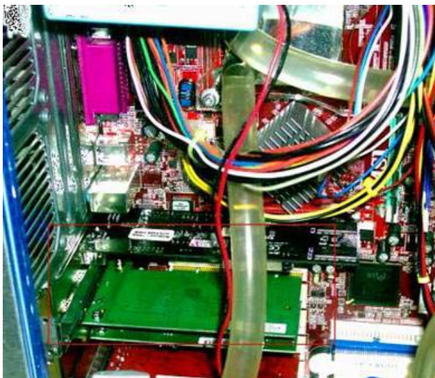
Imatge 3: Instal·lació de la targeta de xarxa (Wireless en aquest cas).
