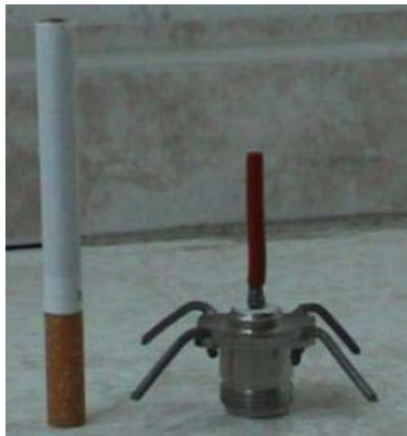
Antena omnidireccional quarter wave per 2.4 GHz
