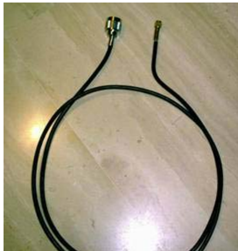
Imatge 6: Pigtail N a SMA-M.
