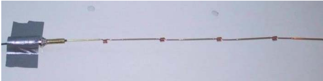
Construcció d'una antena Wireless Omnidireccional de 5 Dbi
