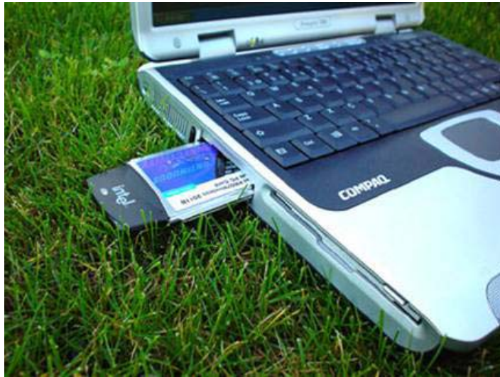
Imatge 5: Instal·lació de la targeta PCMCIA per al portàtil.
