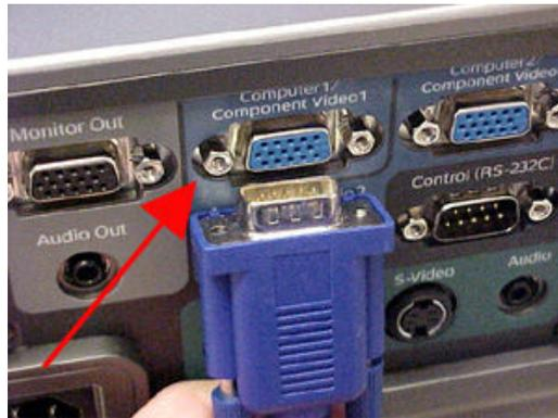
A la banda del canó es connecta el MASCLE, que té una forma irregular en la seva part superior i inferior per tal que no ens equivoquem en el moment de la seva connexió. (NO cal fer força!)
