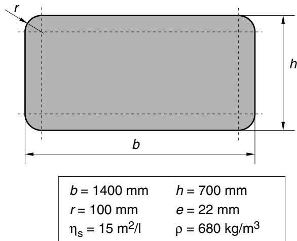
Un fuster ha de tallar el tauler del dibuix amb contraplacat de gruix  $e = 22 \text{ mm}$ , aplacar els cantells amb una làmina de fusta decorativa i donar-li tres capes de vernís a cada cara. La densitat del contraplacat utilitzat és  $\rho = 680 \text{ kg/m}^3$  i el rendiment del vernís és  $\eta_s = 15 \text{ m}^2/\text{l}$  (amb 1 l de vernís es pot donar una capa de vernís a una superfície de  $15 \text{ m}^2$ ). Determineu:
