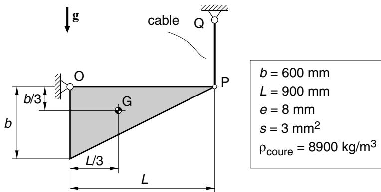
La placa de coure de la figura de gruix  $e = 8$  mm està articulada al punt O i es manté en repòs mitjançant el cable PQ de secció nominal  $s = 3$  mm<sup>2</sup>. Determineu:
