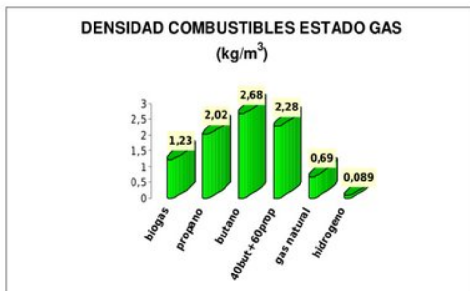
Fig. 7.2. Densidades de los combustibles en estado gaseoso
