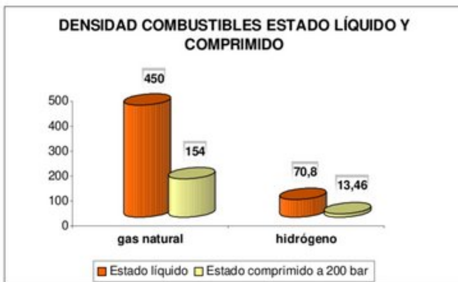
Fig. 7.3. Densidad en estado líquido y comprimido (a 200 bar) del GN y del hidrógeno
