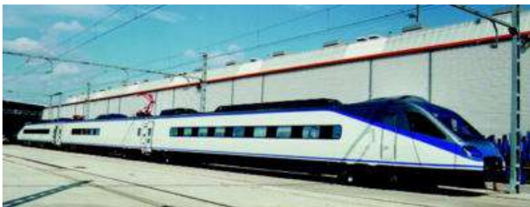
Tren Alaris (Intercity 200) con inclinación natural que compensa las aceleraciones centrífugas de las altas velocidades. Circula por el corredor Valencia-Madrid a una velocidad comercial de 220 km/h. Los construyen conjuntamente ALSTOM y FIAT.
