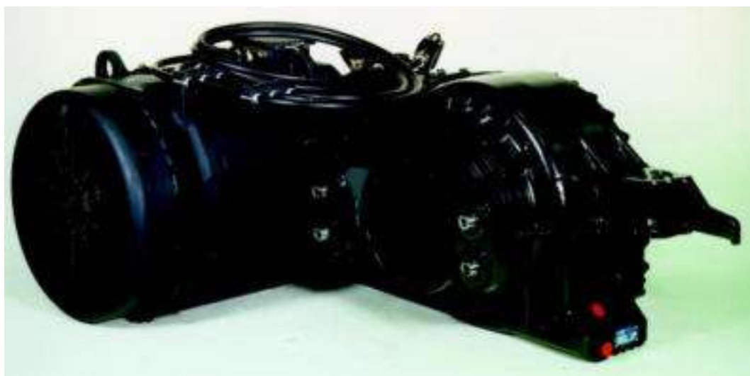
Motor asincron trifásico fabricado por SIEMENS (Cornellá de Llobregat) para los trenes de cercanías UT/447. Esta factoría provee de motores eléctricos a trenes, metros y tranvías de todo el mundo.
