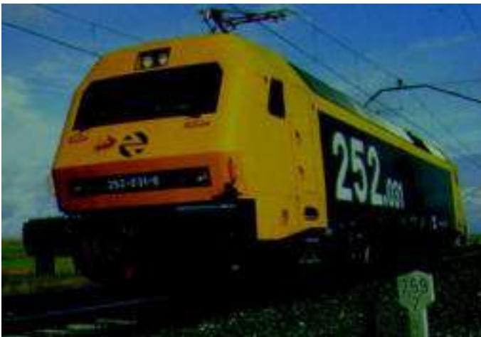
La locomotora de alta potencia S 252, equipada con dos motores de 1,4 MW fabricados por SIEMENS en Cataluña, es una de las más seguras y modernas del mundo.
